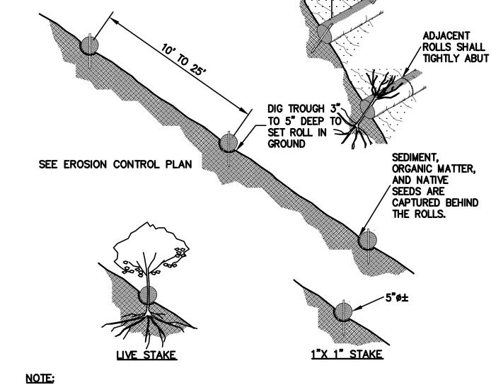
1. STRAW ROLL INSTALLATION REQUIRES THE PLACEMENT AND SECURE STAKING OF THE ROLL IN A TRENCH, 3" TO 5" DEEP, DUG ON CONTOUR. RUNOFF MUST NOT BE ALLOWED TO RUN UNDER OR AROUND ROLL.
